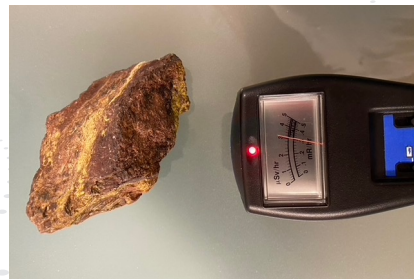
Die Strahlung eines uranhaltigen Steins ist leicht zu messen.
